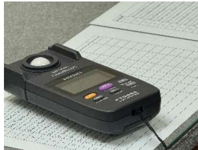
เครื่องวัดความเข้มแสง | Lux Meter Model: FT3424
