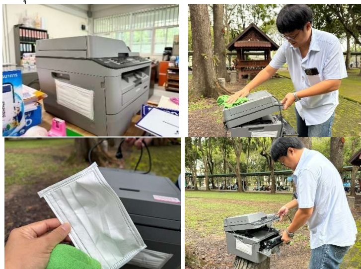
การติดแผ่นกรองคาร์บอนและการทำความสะอาดเครื่องพิมพ์
